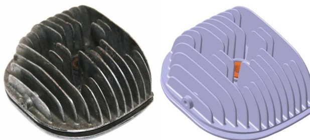
Rys. 8. Zestawienie fizycznego egzemplarza głowicy z jej wirtualnym odwzorowaniem 3D
