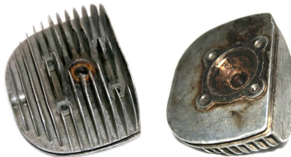
Rys. 1. Głowica silnika Mi10A samochodu Mikrus MR-300
