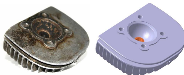
Rys. 9. Fizyczna głowica i jej model w widoku na komorę spalania
