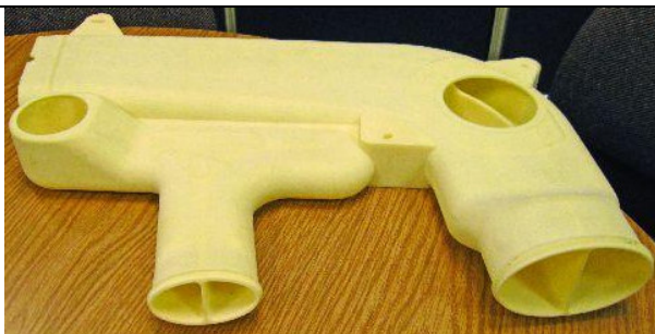
Rys. 3. Kanał wewnętrzny samolotu F/A-18 Hornet wykonywany od wielu lat w technologii AM [5]
