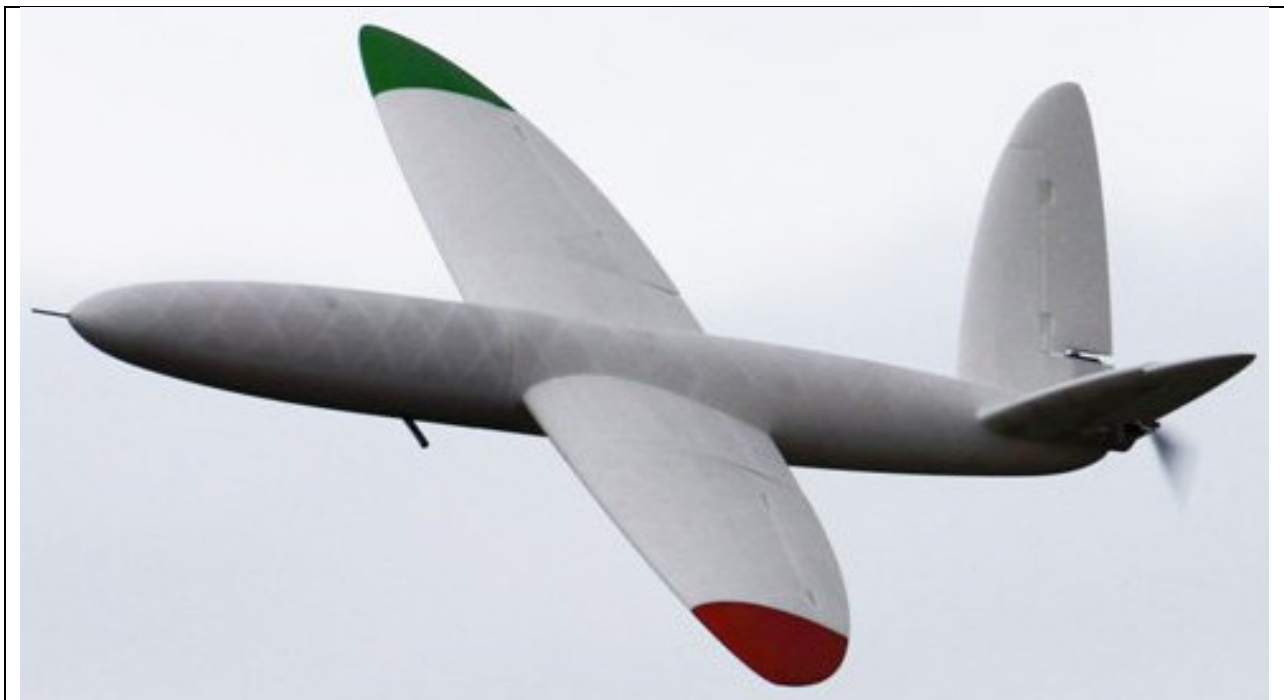
Rys. 12. Bezzałogowy samolot latający (UAV) wykonany w technologii AM na Uniwersytecie w Southampton [4]
