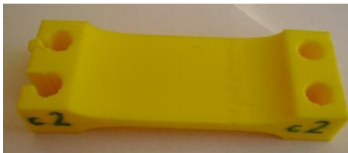
Rys. 8. Widok na próbkę z serii C zniszczoną poprzez rozwarstwienie i wyrwanie części jednego z otworów. Jest to przykład ustawienia nie zalecanego do druku.
