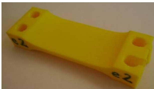
Rys. 12. Widok na próbkę z serii E zniszczoną poprzez rozwarstwienie i wyrwanie części jednego z otworów. Jest to przykład ustawienia nie zalecanego do druku.
