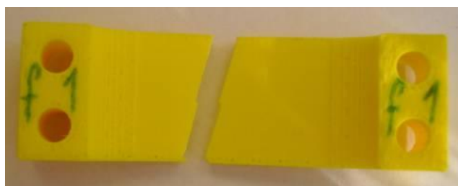
Rys. 14. Widok na próbkę z serii F zniszczoną poprawnie. Jest to przykład ustawienia zalecanego do druku.
