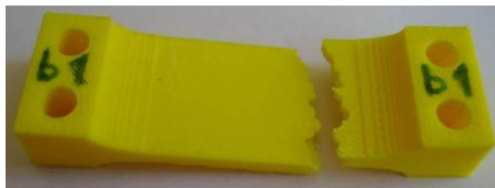
Rys. 6. Widok na próbkę z serii B zniszczoną poprawnie. Jest to przykład ustawienia zalecanego do druku.
