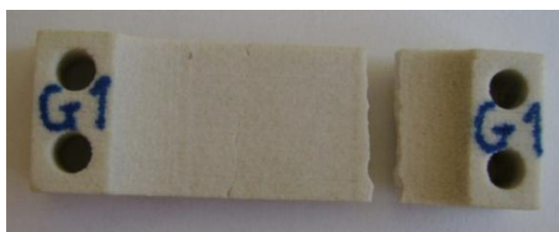
Rys. 16. Widok na zerwaną próbkę wykonaną w metodzie 3DP.
