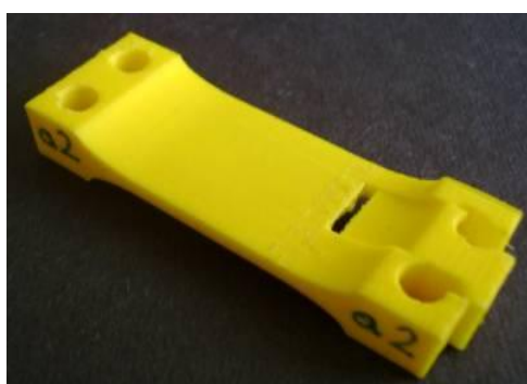
Rys. 4. Widok na próbkę z serii A zniszczoną poprzez rozwarstwienie i wyrwanie jednego z boków. Jest to przykład ustawienia nie zalecanego do druku.
