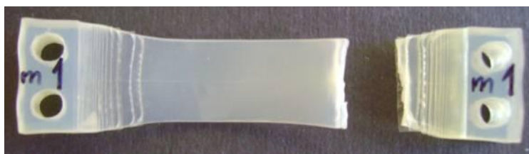
Rys. 22. Widok na próbkę z metody LOM (wykonanej na płask) zniszczoną poprawnie. Jest to przykład ustawienia zalecanego do druku.
