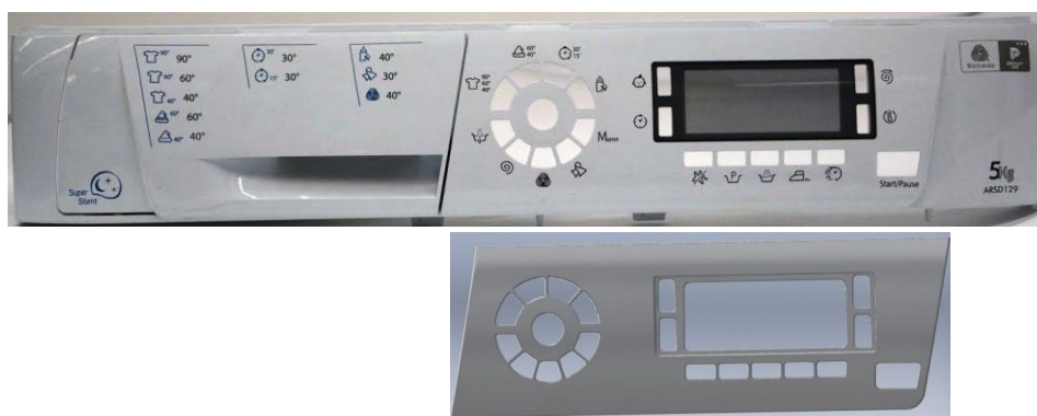
Rys. 9. Panel sterujący pralki Ariston ARSD129 A), model 3D panelu po wczytaniu i obrobieniu chmury punktów B)
