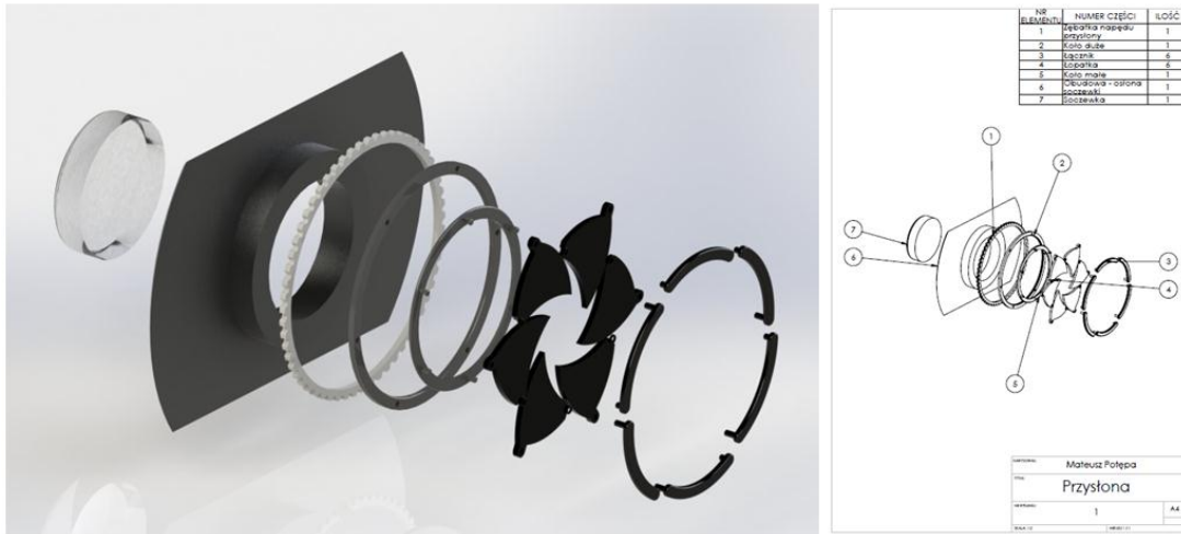
Rys. 10. Elementy optyki i mechanizmu przysłony
