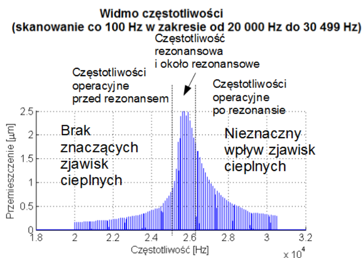
Rys. 3. Główne zakresy częstotliwości operacyjnych i ich wpływ na możliwe zjawiska cieplne dla przykładowego narzędzia ściernego zamocowanego kluczem dynamometrycznym w oprawce z gniazdem na tulejki ER-11
