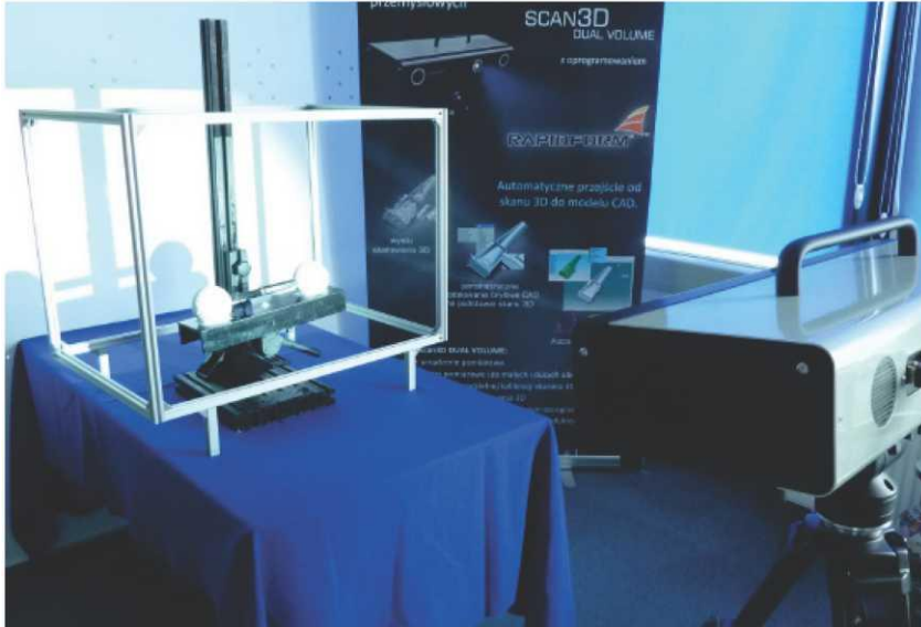
Rys. 3. Stanowisko przygotowane do wykonania weryfikacji dokładności pomiarowej według niemieckiej normy VDI/VDE 2634
