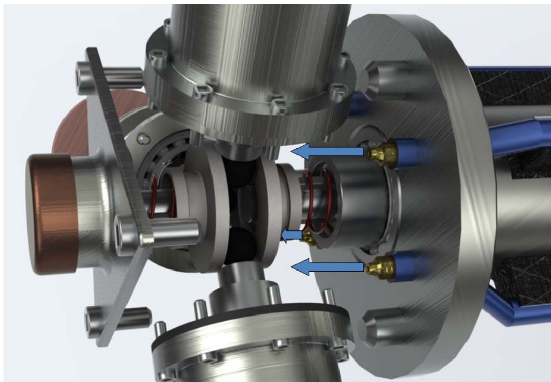
Rys. 5. Chłodzenie przekładni sprężonym powietrzem
