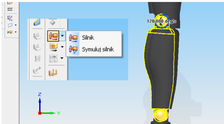
Rys. 23. Zadawanie właściwości silnika symulującego ruch obrotowy
