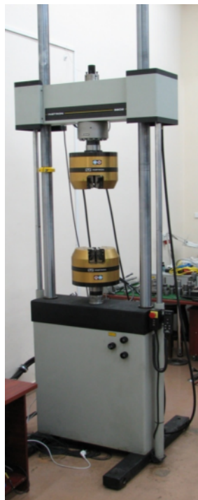
Rys. 3. Maszyna wytrzymałościowa do badań statycznych i dynamicznych INSTRON 8802
