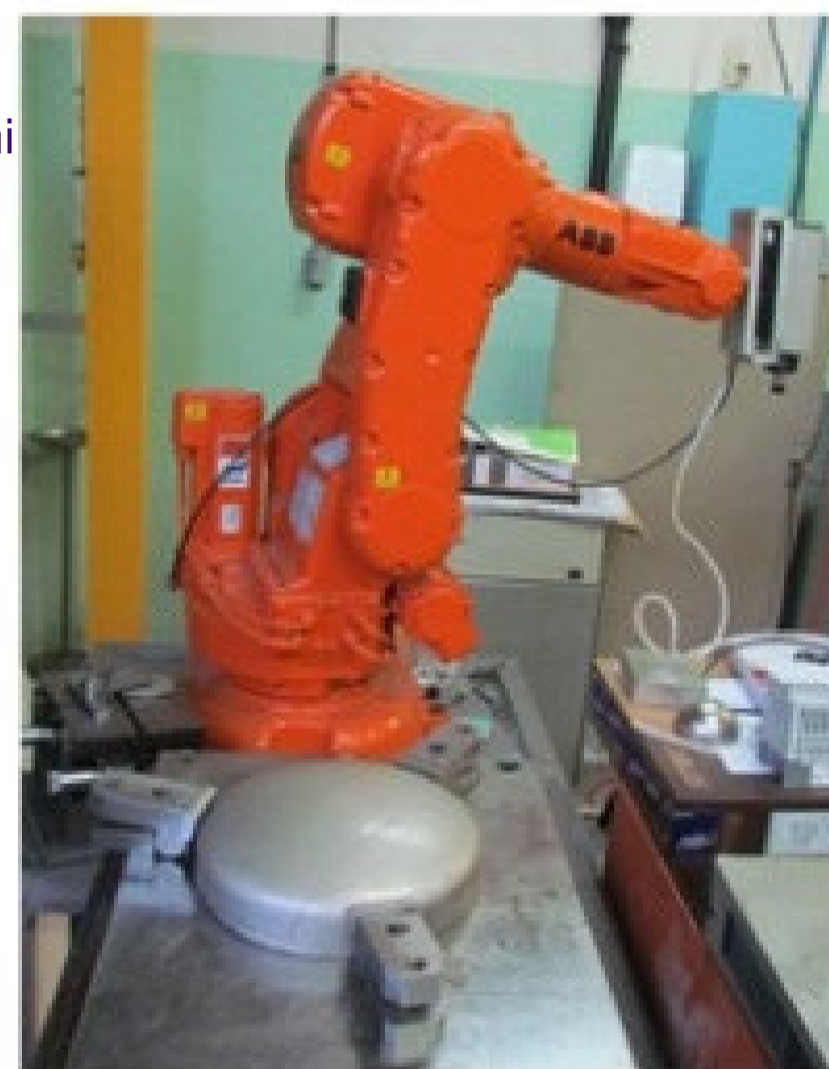
Zastosowanie robota przemysłowego do realizacji procesu wyglądania powierzchni krzywoliniowych z wykorzystaniem aktywnej głowicy obróbkowej
