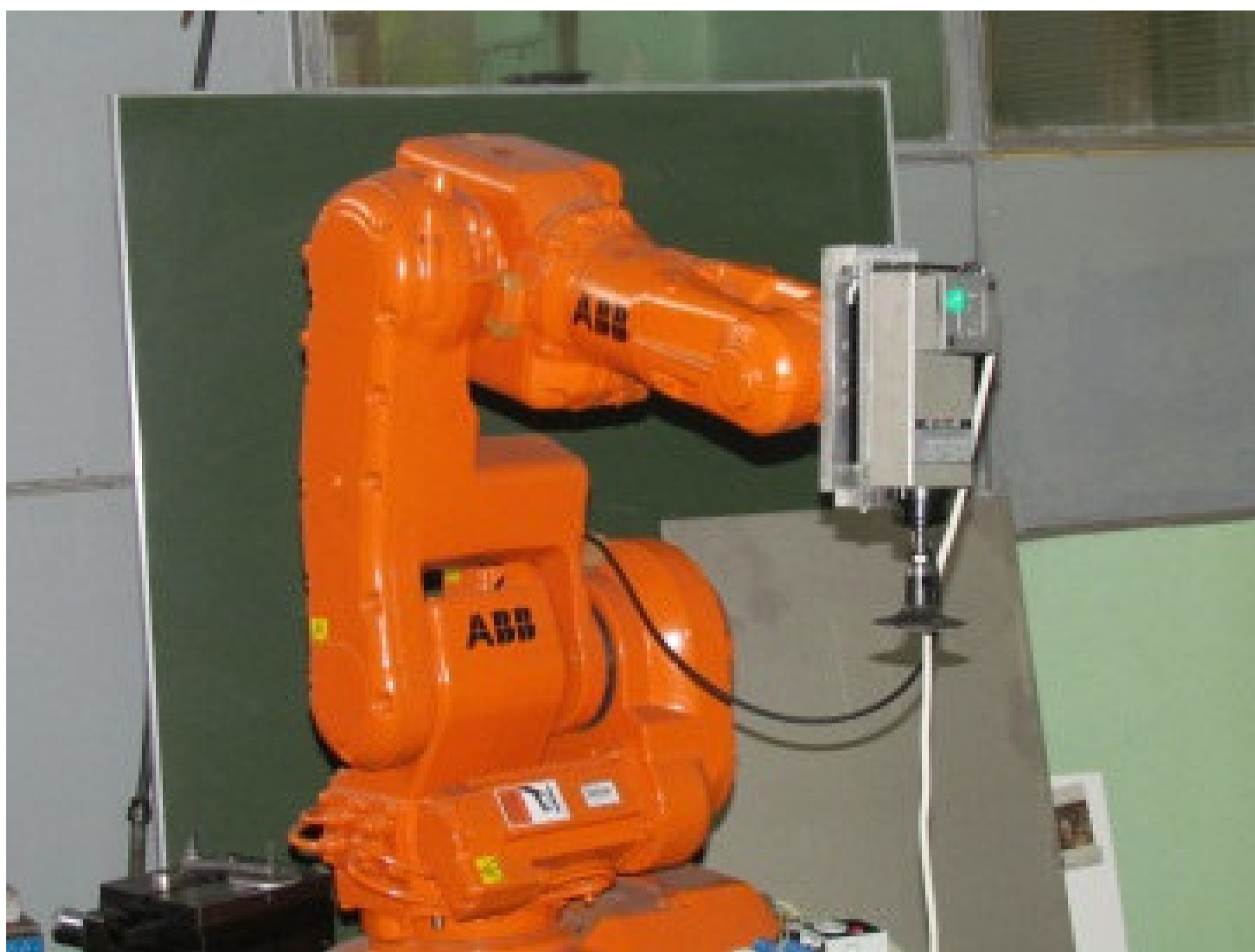
Zastosowanie robota przemysłowego do realizacji procesu wyglądania powierzchni krzywoliniowych z wykorzystaniem aktywnej głowicy obróbkowej
