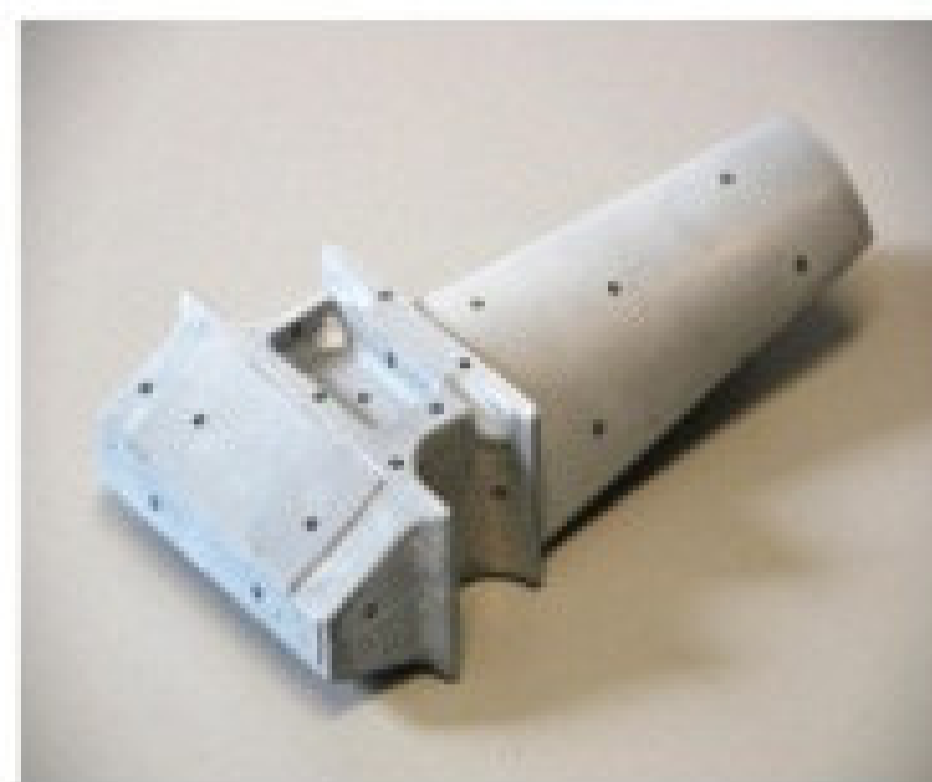
Pozyskanie modelu geometrii 3D poprzez skanowanie obiektu rzeczywistego
