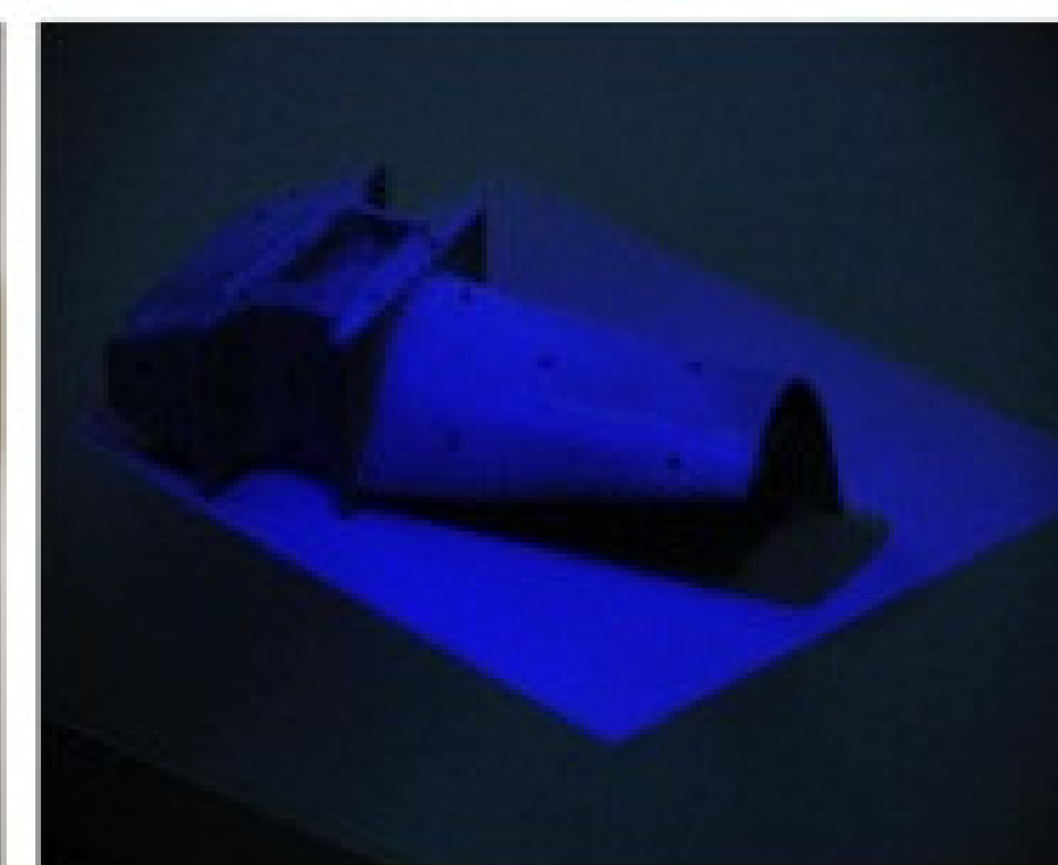
Pozyskanie modelu geometrii 3D poprzez skanowanie obiektu rzeczywistego
