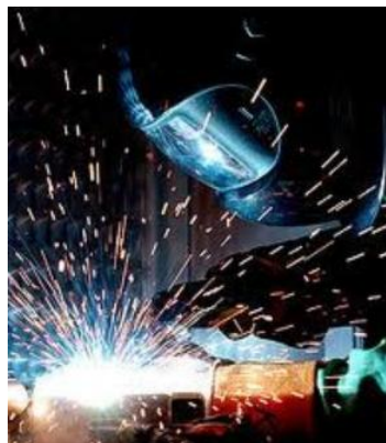
Spawanie elektryczne elektrodą z otuliną
