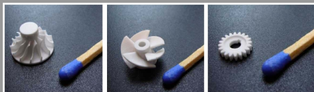
Części ceramiczne spiekane z warst o grubości 2.5 \mu\text{m} .
