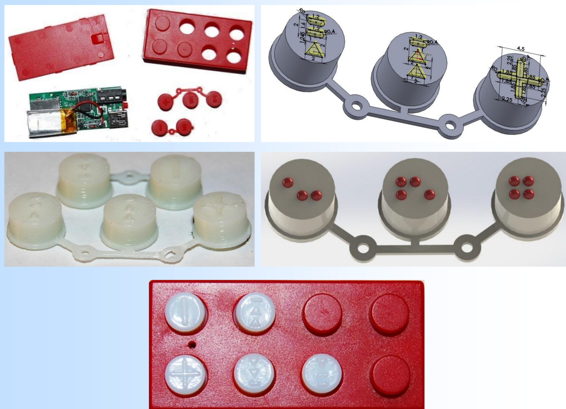
Rys. 2. Etapy modyfikacji odtwarzacza plików audio
