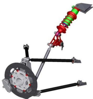
Rys. 7 Model zawieszenia koła przedniego z systemem push-rod
