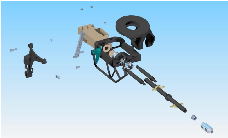
Rys. 21. Rozstrzelenie zespołu działka ATK M230 – mocowania osłony, osłona, silnik, podnośnik, sprężyna, lufa, osłona lufy, mocowanie lufy, amortyzatory, łącznik końcówki, końcówka działka
