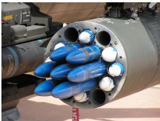
Rys. 8. Wyrzutnia M 261 wraz z rakietami Hydra 70 [5]
