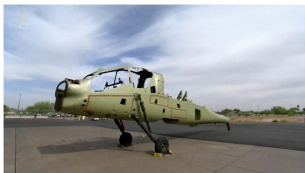
Rys. 1. Goły kadłub śmigłowca Apache. Fragment zrzutu ekranu z filmu Megafabryki: Helikoptery Apache [1]
