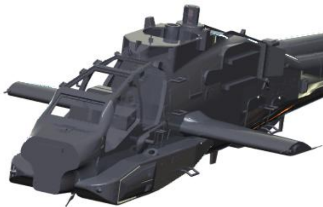
Rys. 2. Trójwymiarowy model kadłuba śmigłowca stworzony w programie typu CAD
