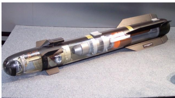
Rys. 5. Przekrój rakiety AGM-114L Longbow Hellfire [3]
