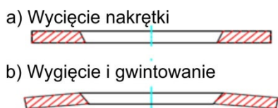
Rys.7 Etapy produkcji nakrętki
