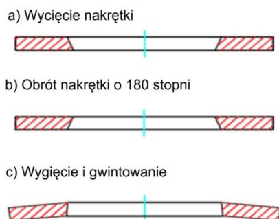
Rys.8 Schemat procesu technologicznego nakrętki po modyfikacjach
