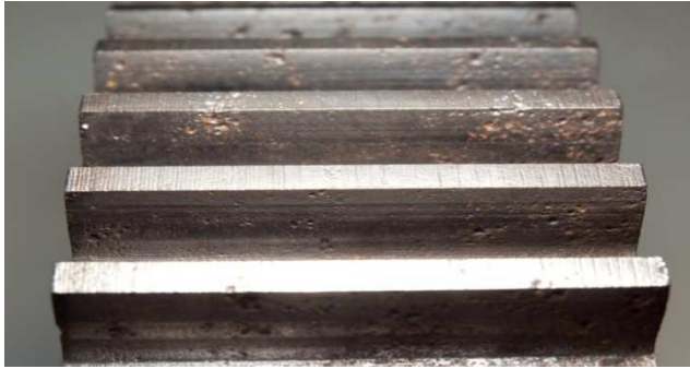
Rys. 3 Powierzchnie zębów koła przekładni walcowej 14/52 po elektrolizie. Widoczne ślady obróbki
