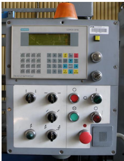
Rys. 1. Elementy stacji załadowczo-rozładowczej: a) podajnik palet, b) panel operatora, c) sterownik PLC
