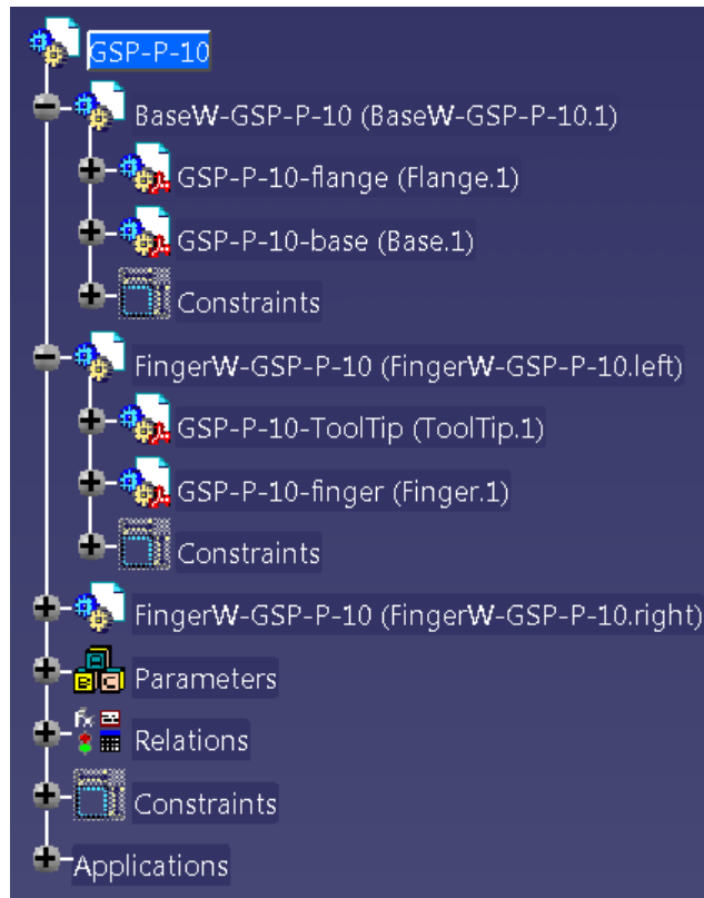
Rys. 4 Struktura modelu chwytaka
