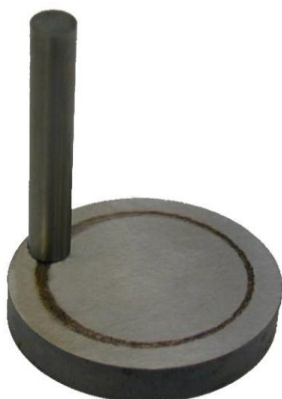
Rys. 21. Zdjęcie węzeł tribologiczny typu trzpień-tarcza [1]
