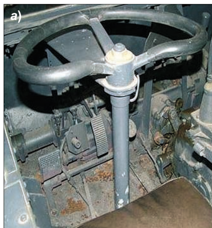
Rys. 1. Kierownica ciągnika artyleryjskiego: a) oryginał, b) kopia
