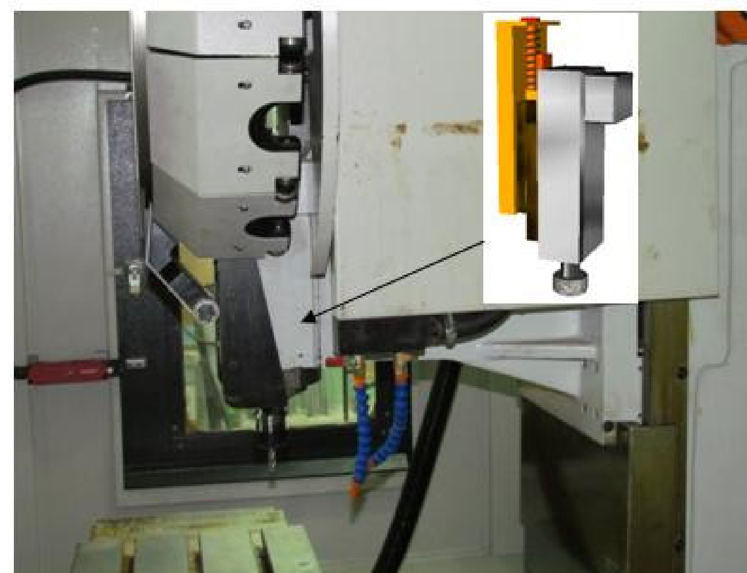
Rys. 9. Widok głowicy obróbkowej przeznaczonej do współpracy z centrum obróbkowym CNC
