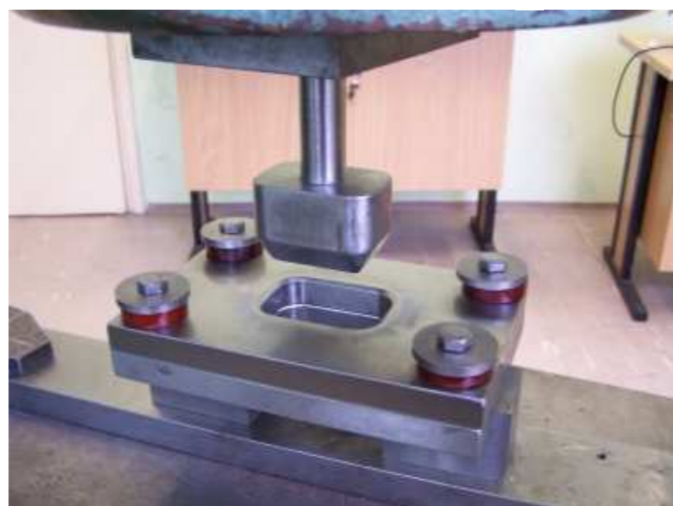
Kształt oraz wymiary przyrządu do kształtowania wytłoczek prostokątnych; 1 – śruba dociskowa, 2 – płyta dociskowa, 3 – stempel, 4 – podkładka elastomerowa, 5 – matryca, 6 – blacha.
