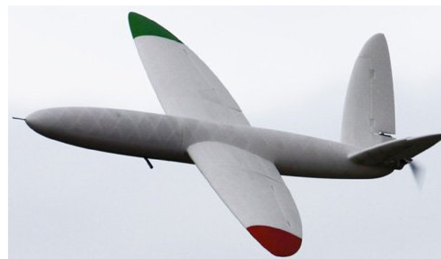
Bezzałogowy samolot latający (UAV) wykonany w technologii AM na Uniwersytecie w Southampton
