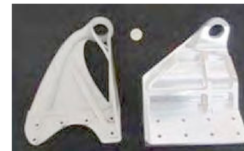
Wspornik z lewej strony wykonany w technologii AM, z prawej strony ten sam wspornik wykończony na obrabiarce CNC
