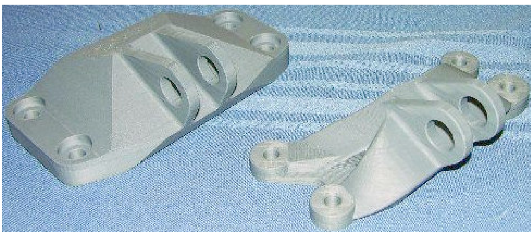
Na rysunku pokazano dwa wsporniki, z lewej strony wykonany tradycyjnie, z prawej zaprojektowany funkcjonalnie z wykorzystaniem już możliwości technologii AM
