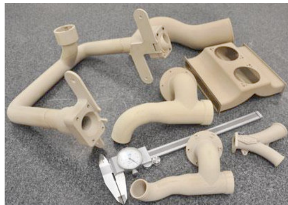
Części oferowane dla przemysłu lotniczego przez firmę Royal Engineered Composites wykonane w technologii AM
