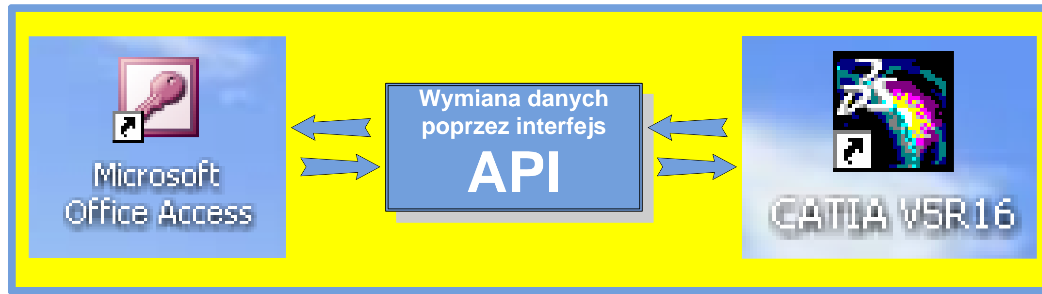
Integracja bazy danych MS Access z systemem PLM Catia za pomocą interfejsu API
