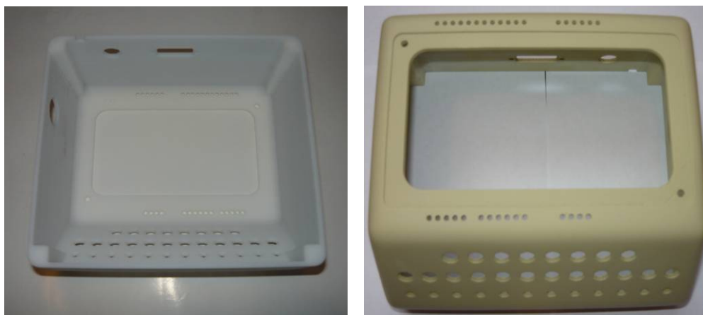
Rys. 3. a) Widok od spodu na obudowę po druku 3D i b) widok od góry po wykończeniu.
