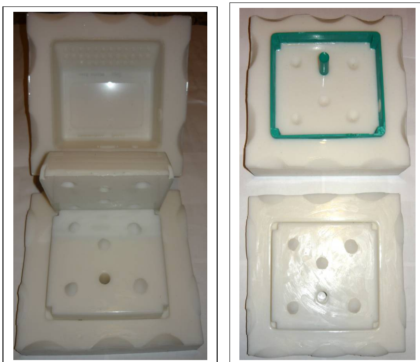
Rys. 5.a) Widoki całej formy po rozłożeniu oraz b) wykonany z tworzywa chemoutwardzalnego model.
