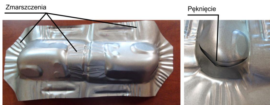
Rys. 1 Zmarszczki i pęknięcie na wytłoczce
