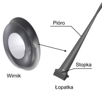
Rys. 6 Wirnik turbiny parowej i konstrukcja łopatki
